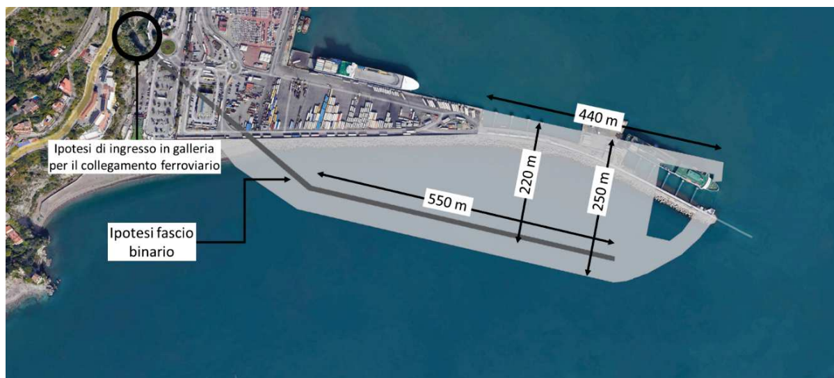
Figura 6. Proposta PRP 2024: Rafforzamento in ampliamento del molo sottoflutto
