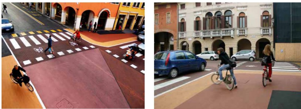
Fig. 0.9 Esempio di attraversamento con specifica pavimentazione
