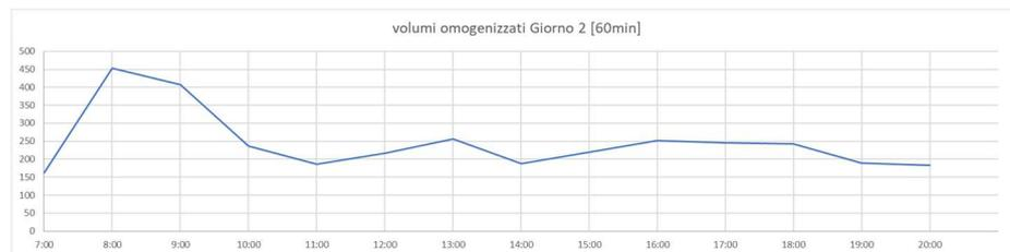
Per la sezione 29 si riscontra un'ora di punta tra le 08:00 e le 09:00 con un flusso massimo di 441 veic/h, pari a circa il 62% della capacità massima della sezione (715 veic/h) e un flusso minimo pari a 47 veic/h osservato nell'intervallo 20:55-21:55.
