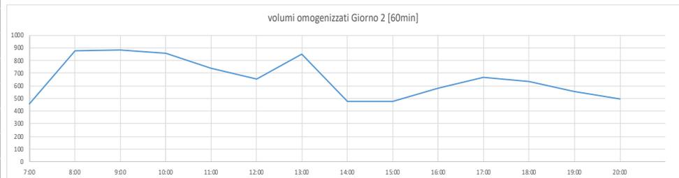
Per la sezione 6 si riscontra un'ora di punta tra le 08:00 e le 09:00 con un flusso massimo di 874 veic/h, pari a circa il 70% della capacità massima della sezione (1244 veic/h) e un flusso minimo pari a 175 veic/h osservato nell'intervallo 20:55-21:55.
