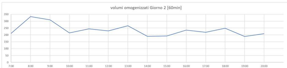
Per la sezione 84 si riscontra un'ora di punta tra le 08:00 e le 09:00 con un flusso massimo di 327 veic/h, pari a circa il 26% della capacità massima della sezione (1244 veic/h) e un flusso minimo pari a 68 veic/h osservato nell'intervallo 20:55-21:55.
