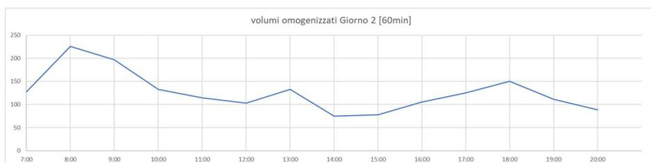
Per la sezione 84 si riscontra un'ora di punta tra le 08:00 e le 09:00 con un flusso massimo di 212 veic/h, pari a circa il 17% della capacità massima della sezione (1244 veic/h) e un flusso minimo pari a 30 veic/h osservato nell'intervallo 20:55-21:55.
