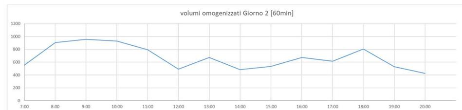
Per la sezione 7 si riscontra un'ora di punta tra le 08:00 e le 09:00 con un flusso massimo di 967 veic/h, pari a circa il 75% della capacità massima della sezione (1296 veic/h) e un flusso minimo pari a 159 veic/h osservato nell'intervallo 20:55-21:55.
