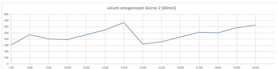
Per la sezione 39 si riscontra un'ora di punta tra le 12:00 e le 13:00 con un flusso massimo di 657 veic/h, pari a circa il 107% della capacità massima della sezione (611 veic/h) e un flusso minimo pari a 167 veic/h osservato nell'intervallo 20:55-21:55.
