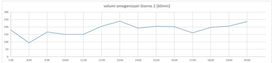
Per la sezione 8 si riscontra un'ora di punta tra le 13:00 e le 14:00 con un flusso massimo di 229 veic/h, pari a circa il 18% della capacità massima della sezione (1296 veic/h) e un flusso minimo pari a 80 veic/h osservato nell'intervallo 07:55-08:55.
