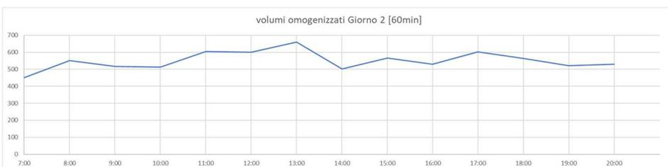
Per la sezione 46 si riscontra un'ora di punta tra le 12:00 e le 13:00 con un flusso massimo di 675 veic/h, pari a circa il 50% della capacità massima della sezione (1339 veic/h) e un flusso minimo pari a 192 veic/h osservato nell'intervallo 20:55-21:55.
