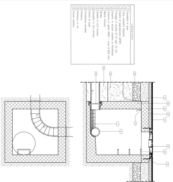
Pozzetto di sezione in curva
