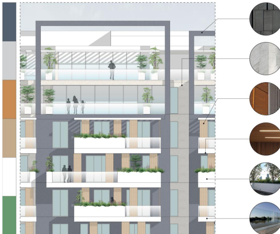
ZOOM porzione di prospetto con indicazione materiali
