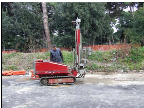
FOTO : PENETROMETRO STATICO DINAMICO TG 63 200 kN, PAGANI, PROVA DPSH 1
