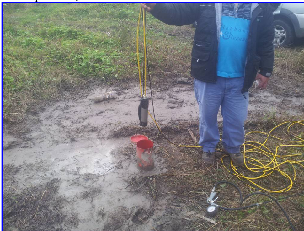
Fig. 9 – Sonda geofonica da foro a tre componenti (3 geofoni Geospace a 4.5Hz).
