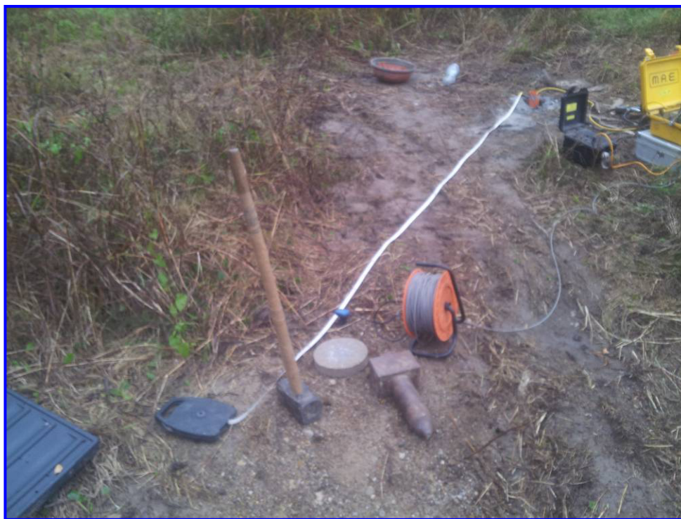
Fig. 8 – Sorgente energizzata, costituita da massa battente su piastra di alluminio e su un cuneo di acciaio infisso nel suolo. Come starter/trigger è stato utilizzato un geofono verticale Geospace a 14Hz.
