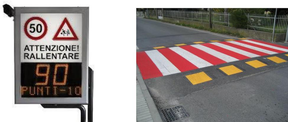
**Figura 1 - Sistemi di riduzione della velocità**
