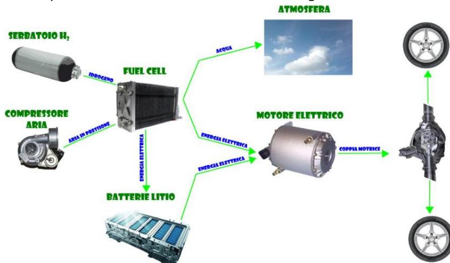
Figura 35- Elementi che costituiscono l'autobus a fuel cell (FCEB)
