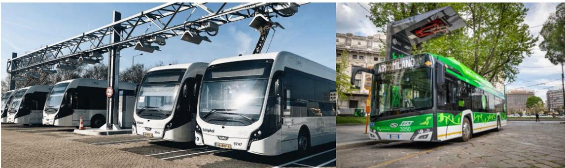
**Figura 37-** a) Infrastruttura di ricarica con pantografo ai capolinea, b) alla fermata
