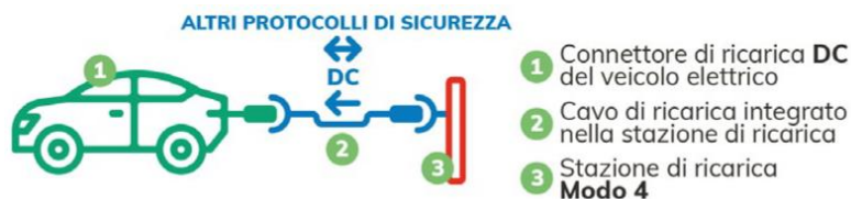
Figura 28 - Modo 4 di ricarica (CEI, 2022)
