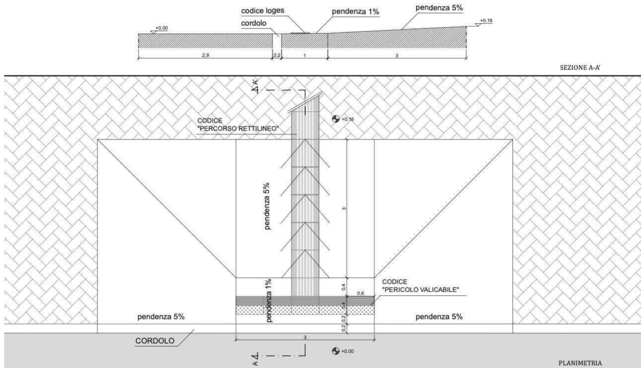
IN CORRISPONDENZA DEGLI ATTRAVERSI PEDONALI, QUALORA IL MARCIAPIEDE ABBAIA UNA QUOTA IN RILEVATO RISPETTO A QUELLA DEL PIANO STRADALE, È NECESSARIO REALIZZARE UNO SCIVOLO DI RACCORDO CON PENDENZA MASSIMA 8% (SUGGERITO 5%) DI LARGHEZZA ALMENO PARI ALL'ATTRAVERSAMENTO STESSO (MINIMO 2,5 METRI).
