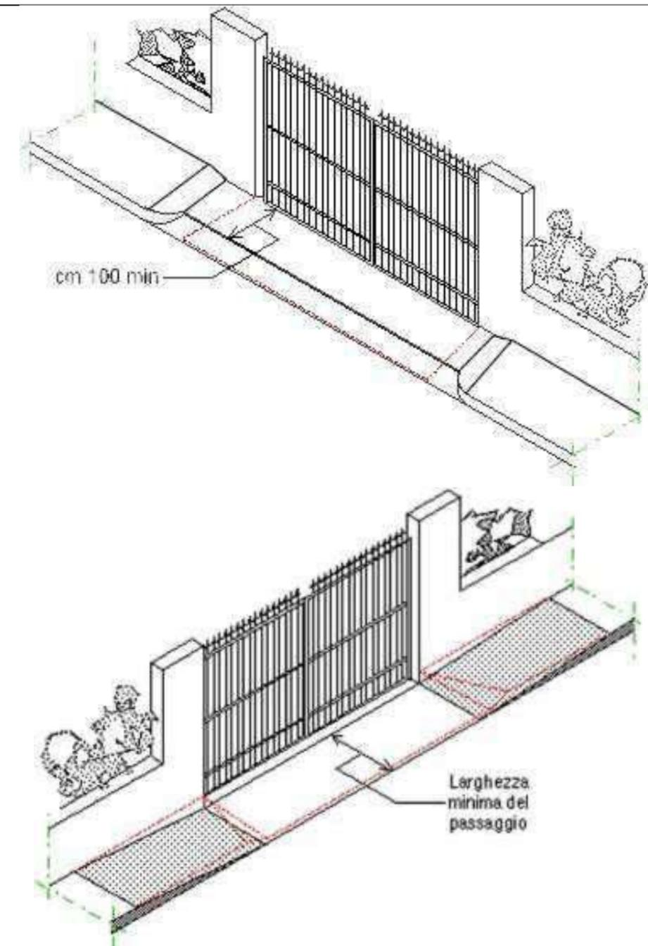
IN CORRISPONDENZA DI UN PASSO CARRAIO, NEL CASO DI PRESENZA DI MARCIAPIEDE RIALZATO RISPETTO ALLA CARREGGIATA, È NECESSARIO GARANTIRE LA PERCORRIBILITÀ DEL PERCORSO ATTRAVERSO DUE POSSIBILI INTERVENTI:
