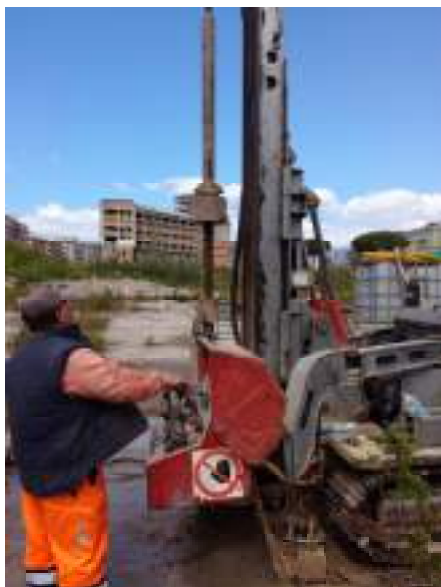
Foto 1 Esecuzione prova SPT nel foro di sondaggio S1
