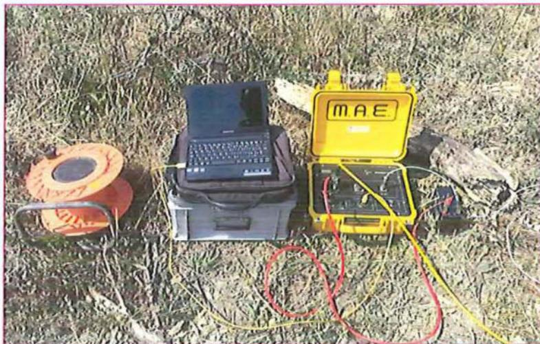
Attrezzatura prova sismica
